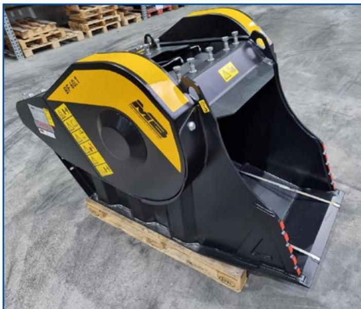
▲ O implemento de britador móvel MB Crusher BF60.1 para escavadeira hidráulica. Foto: divulgação MB Crusher
