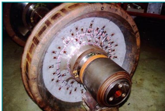
▲ Vagão instrumentado (acima) com destaque para as caixas do sistema, GPS e painel solar para alimentação de energia. Rodeiro instrumentado (abaixo) com vários strain gauges instalados na roda.
