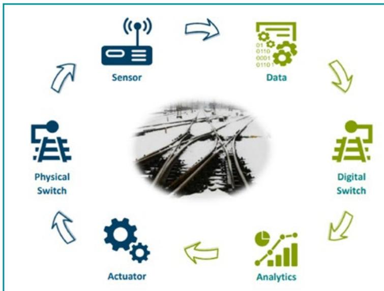
▲ Esquemático com as etapas de um Gêmeo Digital aplicado em AMV de uma ferrovia europeia.
