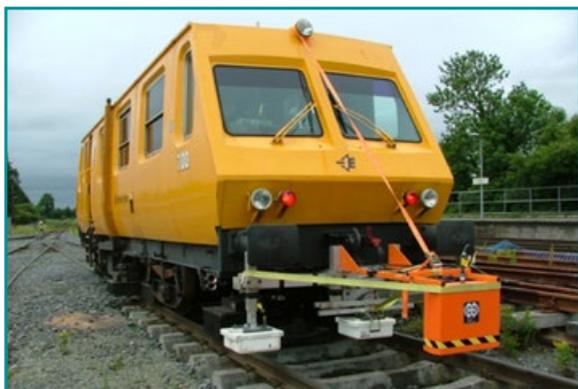
▲ Carro controle EM 50 da ferrovia irlandesa com as quatro antenas de GPR instaladas na parte frontal.
