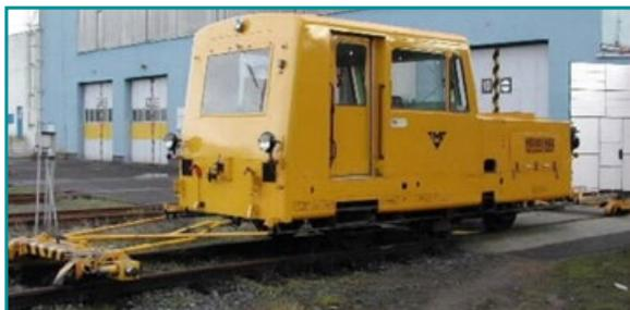
▲ Carro controle modelo Matisa PV6 montado e em posição de medição de via (Todas as fotos: coleção dos autores).
