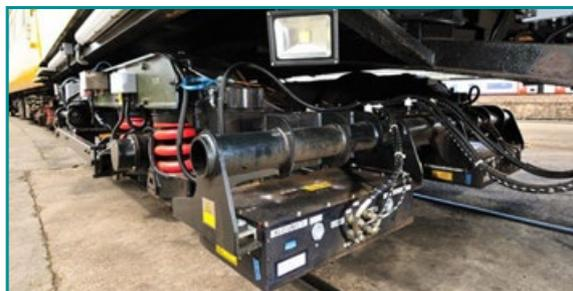
▲ Equipamento portátil de ultrassom de trilhos embarcado em um carro de passageiros na Network Rail.
