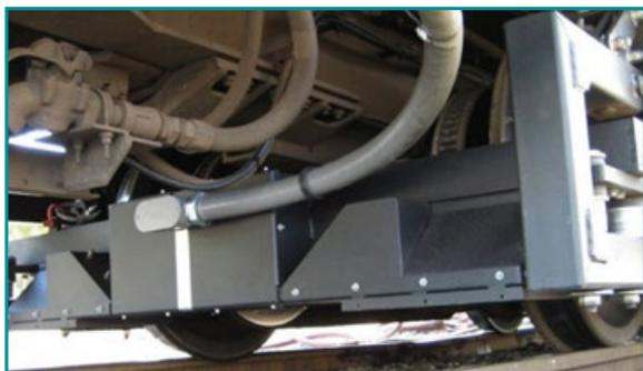
▲ Equipamento de inspeção embarcada, instalado a frente do rodeiro de um vagão.
