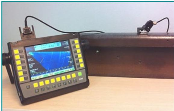
▲ Equipamento portátil phased array para inspeção de trilhos.
