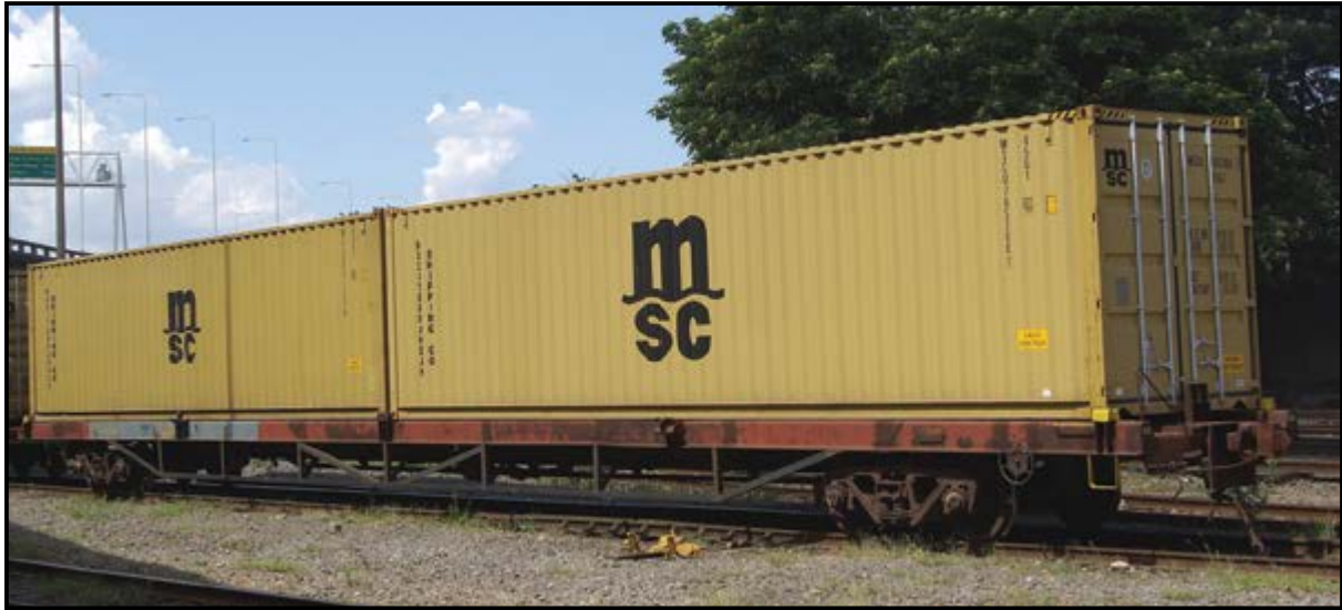
▲ Vagão adaptado dos antigos transportadores de automóveis, agora carregado com dois contêineres de 40 pés no Arará. Foto: João Bosco Setti
