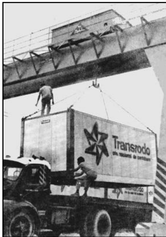
▲ A RVPSC denominou Rodotrem seu serviço pioneiro de transporte por contêineres. Na foto uma operação de carga e descarga entre trem e caminhão na antiga estação de Curitiba (foto: RFFSA).
