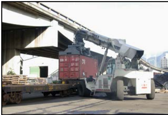
▲ Carregamento de um contêiner 20 pés em um vagão no Arará, por uma moderna empilhadeira telescópica. Foto: João Bosco Setti
