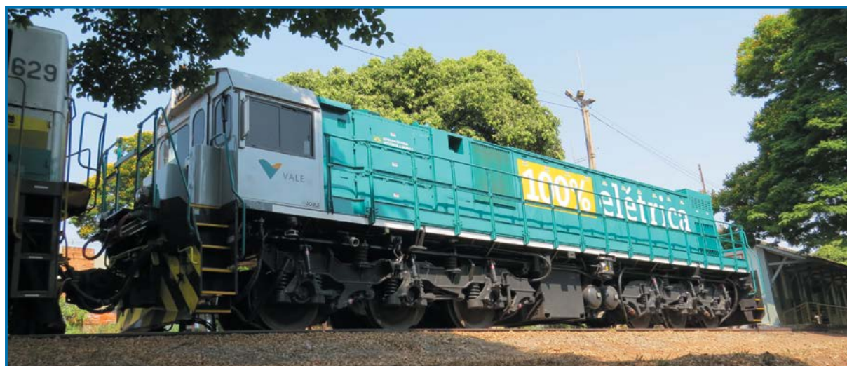
▲ A locomotiva EFVM 404, movida a baterias recarregáveis, quando em manobras no pátio de Prudente de Moraes, próximo a Sete Lagoas, MG, logo após sua entrega pela Progress, em setembro de 2021 (Fotos: Waldemar Ogando Filho).
