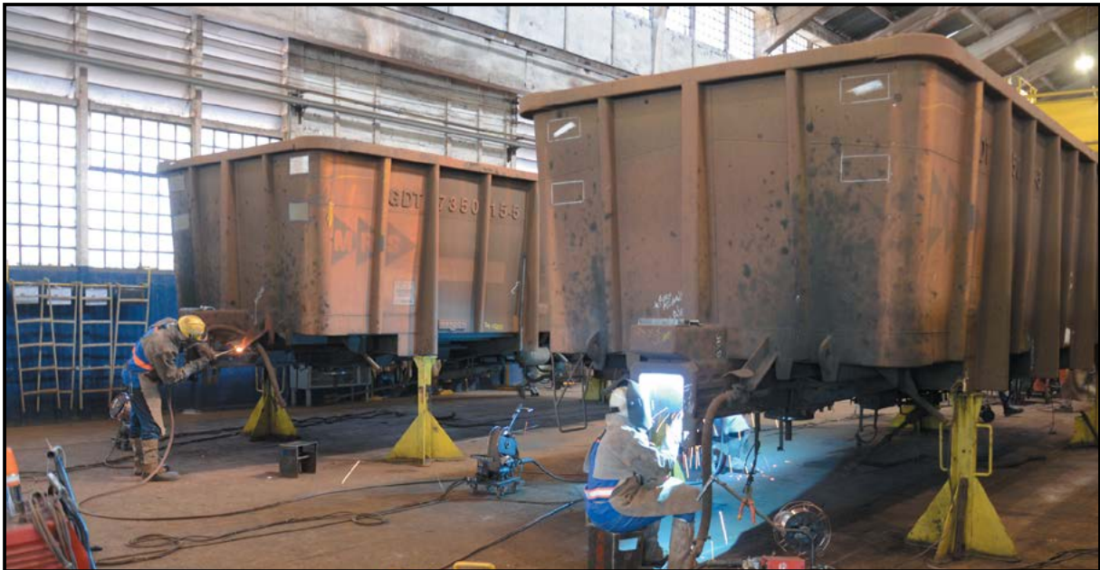
▼ Metalúrgicos atuando na manutenção de vagões ferroviários (Foto: João Bosco Setti).
