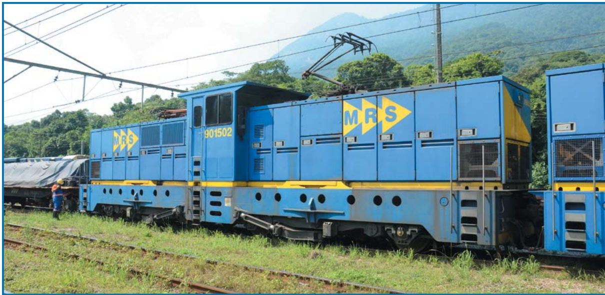
▲ Locomotiva elétrica de fabricação Stadler em operação no trecho de cremalheira da MRS Logística (Foto: João Bosco Setti).
