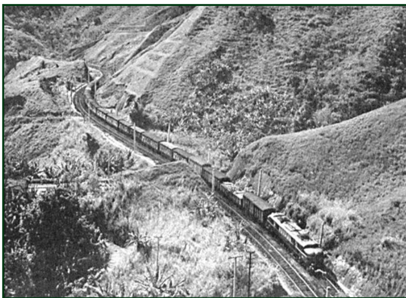
▲ Um trem de carga geral da EFCB com vários vagões da EFSJ tracionado por uma das locomotivas elétricas 2-C+C-2 “Escandalosa”. (coleção Hugo Azevedo Caramuru)
