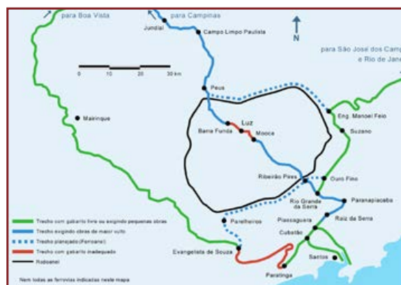
▲ As principais linhas de carga no entorno de São Paulo, com as indicações referentes ao Ferroanel Sul e Norte, e ao gabarito necessário aos Double Stack. Fonte: mapa baseado no Google.
