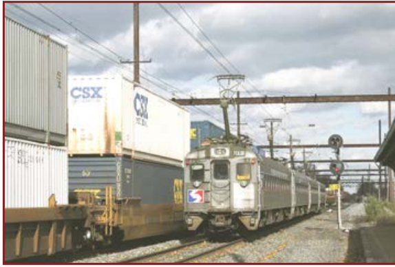
▲ Trecho de linha na Costa Leste dos Estados Unidos com a rede aérea em altura elevada. Fonte: Wikipedia.
