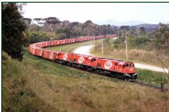
▲ Um trem de carga da ALL após concluir a subida da Serra do Mar, já se aproximando da região de Curitiba. As locomotivas G22U, fabricadas pela Macosa da Espanha, sob licença da General Motors / EMD, foram adquiridas nos anos 70 pela RFFSA especialmente pensadas para tracionar os trens no trecho Paranaguá-Curitiba, onde operaram por décadas. Foto: divulgação ALL.
