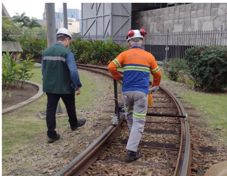
Figura 5: Medição do coeficiente de atrito na pêra do terminal dos Bondes
