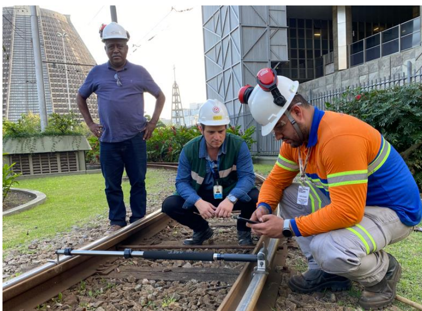
Figura 5: Medição de desgaste na curva da pêra do terminal dos Bondes
