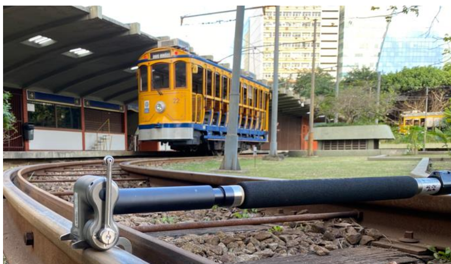
Figura 5: Perfilômetro digital de trilhos Miniprof Rail.
